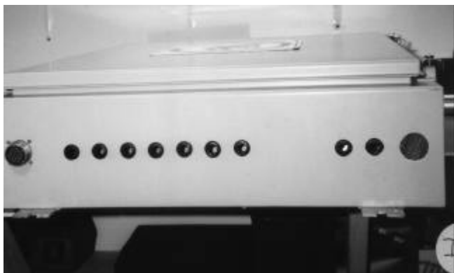
D: Vue du dessous de la B.J. On remarque à gauche le connecteur femelle qui sert à relier la B.J. Et la console de commande. Ensuite les trous pour les câbles coaxiaux complètement à droite l'orifice de ventilation.
