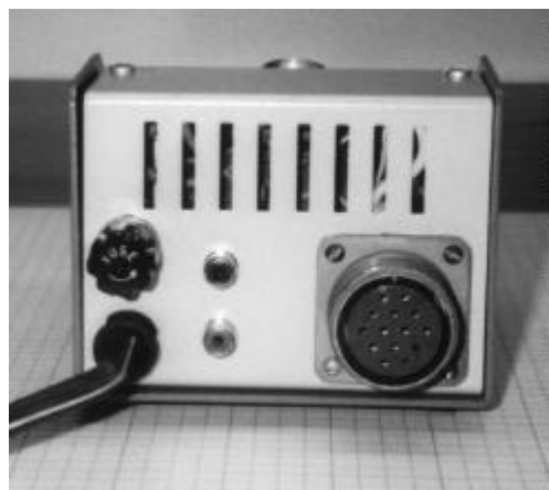
B: Vue arrière de la console de commande. On remarque à droite le connecteur femelle du câble reliant la console à la B.J. extérieur télécommandée. Également J10 et J11 (R.C.A phono jock)
