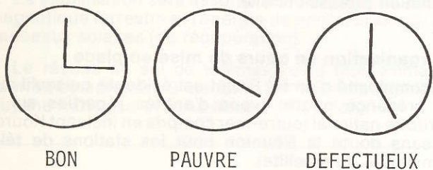
FIGURE 3 : vérification d'un transistor ou d'une diode.
