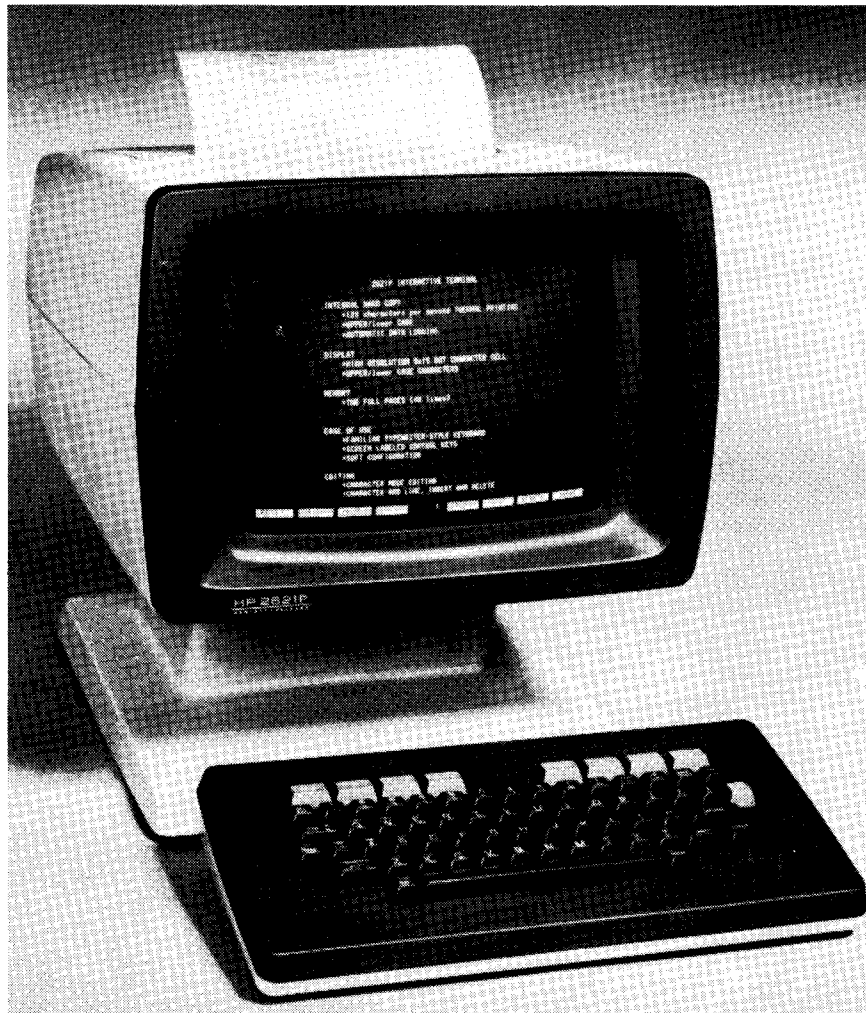
Des équipements du type de ce terminal communiquent généralement en mode "SÉRIE".
