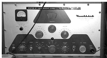
Heathkit DX-100 assemblé par VE2ME. Le premier émetteur de VE2BJZ.
