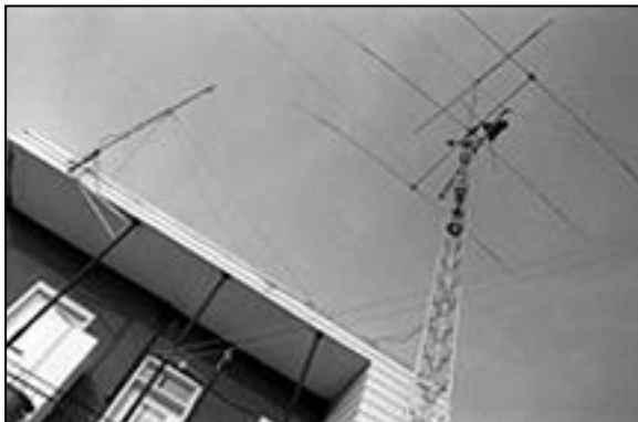
Armand VE2DVZ - Sans interférence 14 éléments pour le 2 mètres 3 éléments pour 10, 15 et 20 mètres 1 dipôle pour le 40 et 80 mètres
