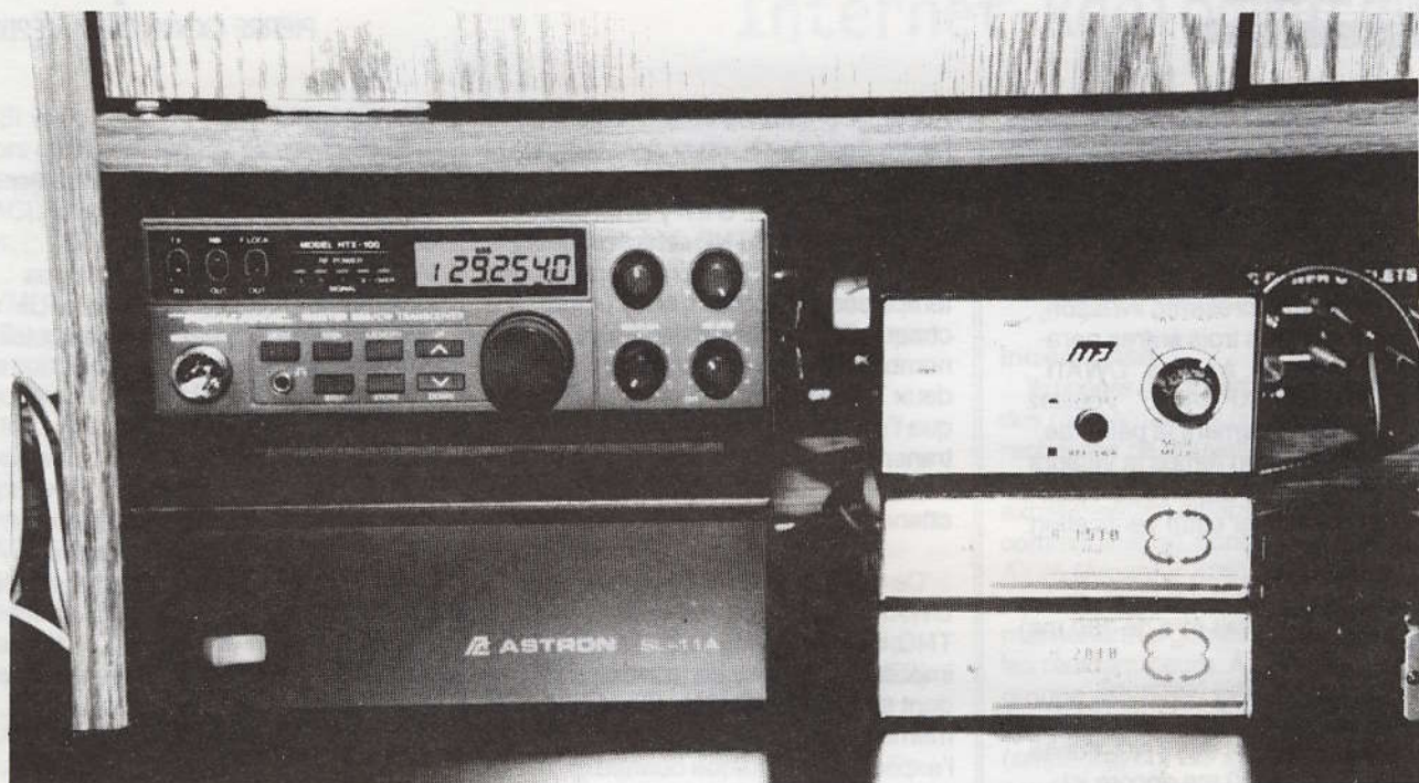
Ma station HF intégrant un convertisseur 20m et 15 m
